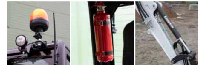
Kennleuchte Feuerlöscher Langer Löffelstiel
