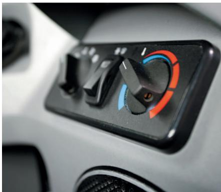
Die direkte Kabinentemperatursteuerung der Klimaanlage- und Heizungsoption schafft das ganze Jahr über ein angenehmes Arbeitsklima.
